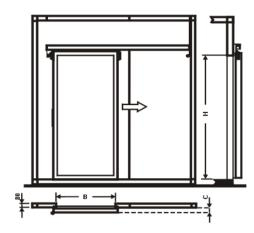
Откатные двери изготовлены из листового крашенного металла с пенополиуретановым наполнителем. По периметру полотно двери укреплено профилем из пищевого алюминия. Дверь снабжена высокозластичным сменным резиновым уплотичтелем. В конструкции применяется специальное запорное устройство позволяющее автоматически под собственным весом двери достигать надежной герметизации.
