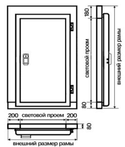
Распашные одностворчатые двери изготовлены из листового крашенного металла с пенополиуретановым наполнителем. По периметру полотно двери укреплено профилем из пищевого алюминия. Дверь снабжена высокоэластичным сменным резиновым уплотнителем.
