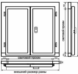
Распашные двухстворчатые двери изготовлены из листового крашенного металла с пенополиуретановым наполнителем. По периметру полотно двери укреплено профилем из пищевого алюминия. Дверь снабжена высокоэластичным сменным резиновым уплотнителем.
